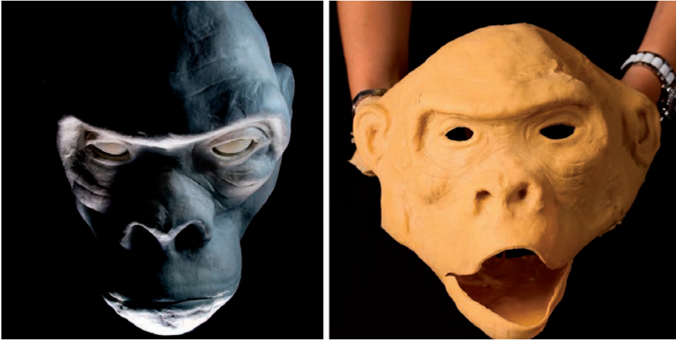
Figura P.5 - Un modello di base per la testa di un animatrone-gorilla e un rivestimento in lattice derivato dal modello.
